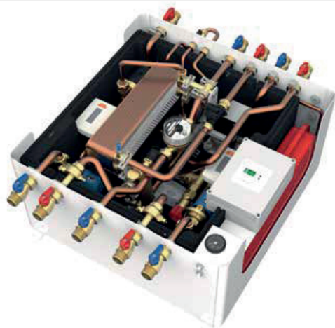
HC IVAR ESAT DUAL: satellite di utenza ad acque separate, a doppio scambiatore e produzione simultanea di acs, per applicazioni di riscaldamento e di raffrescamento. È fornito di connessioni per due circuiti primari separati: circuito primario di acqua calda per la produzione istantanea di acs e circuito primario di acqua calda o gelida per riscaldamento invernale o raffrescamento estivo.
