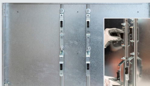
1. LE STAFFE (interasse 200 mm e profondità complessiva 80 mm), vanno inserite nella cassetta murale in acciaio zincato, regolabile in altezza e profondità e allineate in altezza
